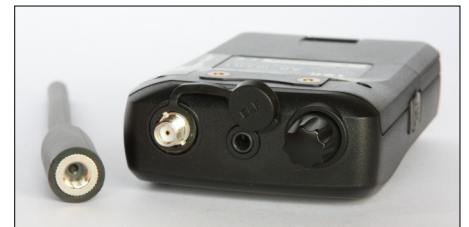
Bild 2: Oben liegen Anschlussbuchsen für die Antenne und einen Ohrhörer.
