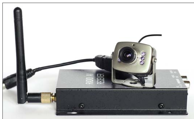
Bild 4: Typische Funkkamera für den 2,4-GHz-ISM-Bereich
